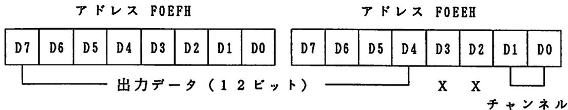
出力データ形式は前のA/Dコンバータの場合と同様に、12ビット正負表現データである。下位のD3とD2の値は関係ない。また、下位D1とD0でチャンネルを選択する。例えば、チャンネル1にデータC00Hを出力、すなわち、
