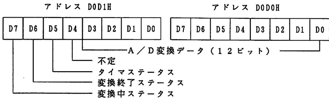
この中で、上位D7の変換中ステータスは「1」の時には変換中であることを示す。従って、このビットが「0」であることを確認して16ビットデータを読み込む。よって、
